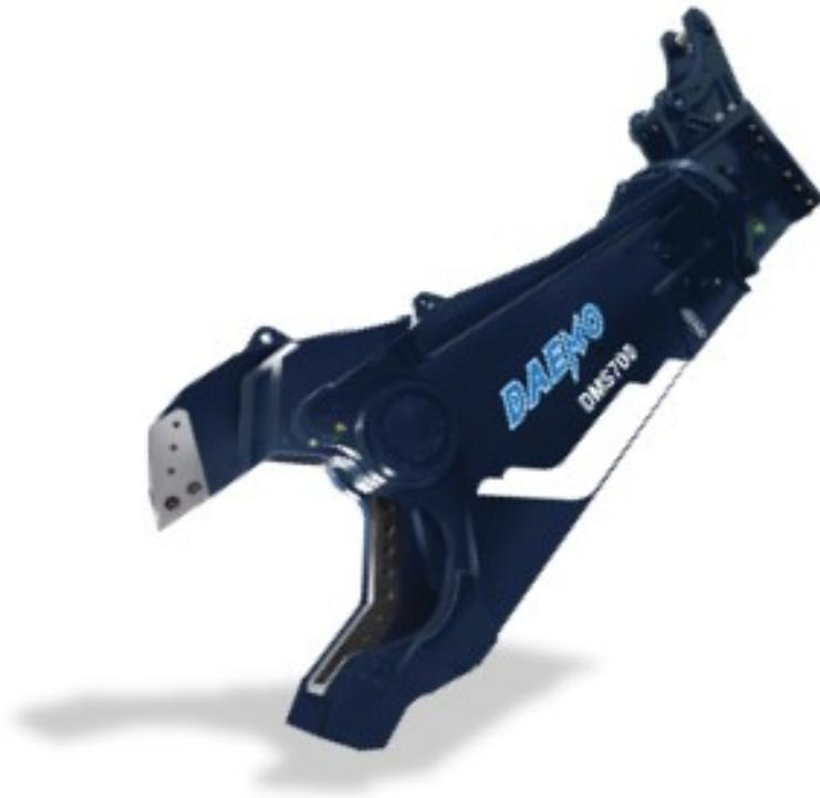
쉐어는 국내에서 흔히 '고철용 가위'로 불리며 고철장 및 제철소에서 고철 및 빔을 원하는 크기로 절단하는 용도로 사용됩니다. 과거 사람이 산소절단을 하던 시스템에서 굴삭기의 대형화 추세에 맞춰 50톤급 이상으로 대형화 되어 가고 있습니다. 2.0톤~36톤은(7기종) 일반 가위처럼 커터블레이드로만 구성되어 있는 None Guide Block Type이며, 4.5톤~100톤은 (5기종) 강철을 자를 시 암의 틀어짐을 방지하기 위해 Guide 형태로 구성되어 있는 Guide Block Type으로 개발되어 있습니다.
