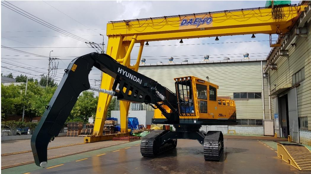
산림장비 3개모델에 대한 개발업체 선정에 따라 산림장비 전용 건설기계 개발을 완료하였습니다. 개발범위는 허용기준에 적합한 ROPS 산림장비용 전용 운전석, 작업장치 및 상부체 전면 보강 장치를 적용하였습니다. 이에 글로벌 시장을 위한 프리미엄급 산림장비를 개발을 통해 수주 확대를 적극 추진하고 있습니다.
