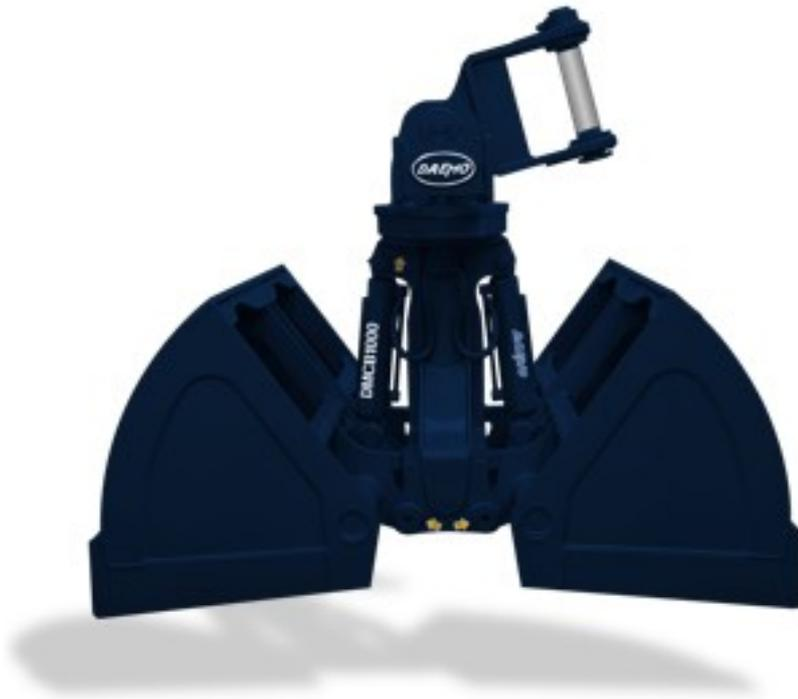
크람셸 버킷은 똑같은 크기의 버킷 두 개를 맞대어 놓은 형상으로 주로 광물이나 곡식과 같이 벌크형태의 작업물을 핸들링 하는데 사용됩니다. 14톤, 20톤, 30톤 제품이 가장 보편적으로 사용되며 당사는 이 중 25~32톤급의 1기종을 보유하고 있습니다. 작업물이 석탄이나 철광석의 경우는 모래나 곡식과 달리 알갱이가 크기 때문에 담기에 편리하도록 버킷 끝단에 Tooth를 옵션으로 판매하고 있으며, 철광석처럼 모래나 곡식보다 질량이 큰 경우 버킷의 내구성을 고려하여 강화철판을 적용한 옵션으로 판매하고 있습니다. 당사의 주요 수출국가인 인도 내 광산개발이 활발해지면서, 석탄 채광 후 핸들링작업에 크람셸 버킷의 수요가 증가하고 있어 향후 수요는 꾸준히늘어갈 것으로 예상하고 있습니다.
