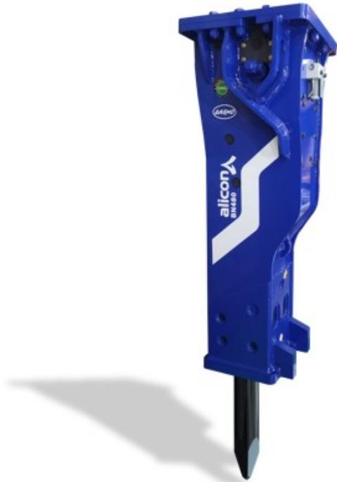
BN 시리즈는 Alicon 시리즈 개선 모델로, 굴삭기 무게 기준 7톤급에서 최대 80톤급 까지 장착 가능한 15모델을 양산하였습니다. BN 시리즈는 품질이나 성능면에서 유럽 선진사 제품과 접근한 제품으로 자리매김 하는 것을 목표로 개발 되었습니다. BN 시리즈는 Alicon 대비 타격에너지를 15% 이상 증대함으로써, 선진사인 E사 동급 모델 대비 타격에너지가 높게 되어 있습니다. 밸브 내장형을 채용하여 효율을 증대 되었으며, 밸브측에 조립되는 부품이 적어 조립이 쉽고 빠릅니다. 프론트 커버 및 치즐핀의 지지면적을 증대함으로써 소모품의 수명을
