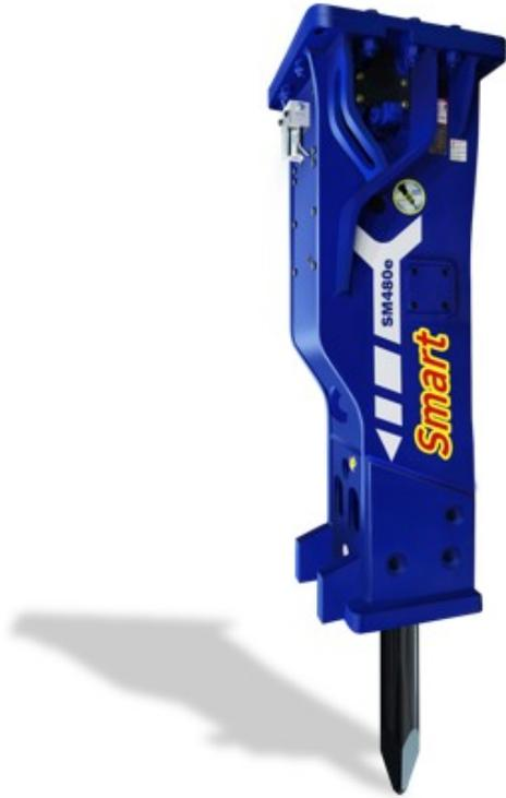
Smart Breaker는 암반 타격시 암반의 강도에 따라서 피스톤의 위치를 감지하여, Stroke유로를 개폐하는 밸브의 제어로 다단 타격력/타격속도를 자동 제어하는 기술이 적용된 오토 스트로크 유압 브레이커입니다. 이 기술을 통해서 강암에서는 고타격력으로, 약암에서는 고타격수로 타격됨에 따라서 작업 효율성이 증대되고, 공타시에는 숏 스트로크로 작동 하여 타격력 반감에 따른 공타력 저하로 프론트 헤드, 장볼트 등 주요 부품의 내구성이 증대됩니다. 또한 작업자의 피로도가 감소되어 대체로 작업자가 선호합니다. 스마트 브레이커는 유압식과 전자식 2종류가 있습니다. 유압식은 유압회로에 의한 유압밸브가 사용되고, 전자식은 전기를 이용한 솔레노이드 밸브가 사용됩니다. 유압식은 7모델, 전자식은 4모델이 판매 되고 있고, 중, 대형급 위주로 라인업이 완료 되었습니다.
