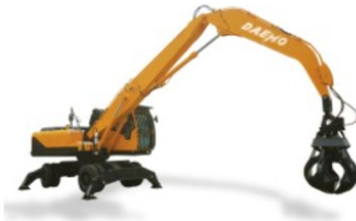
기존 굴삭기의 스탠다드 붐/암 시스템은 작업거리 및 핸들링 할 수 있는 무게에 한계점이 있어 원거리 및 중량물에 대한 특수작업에는 부적합합니다. 이에 원거리/중량물의 작업물을 효율적으로 핸들링할 수 있도록 붐과 암의 길이를 효율적으로 늘려 작업범위를 넓게 제작한 제
