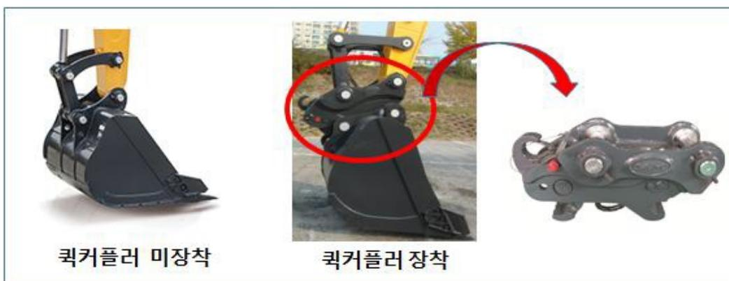
퀵커플러는 굴삭기의 기본 버킷을 포함하여 다양한 어태치먼트 제품을 빠른 시간 내에 교체할 수 있도록 개발된 제품입니다. 과거에는 어태치먼트 교체 시 사람이 직접 굴삭기 끝단에 장착되어 있는 어태치먼트의 핀을 망치로 때려 탈거시킨 후 교체할 어태치먼트의 핀을 끼워 망치로 때려 장착하였습니다. 그러나 퀵커플러를 사용함으로써 빠르고 안전하게 캐빈 내에서 버튼만으로 교체를 할 수 있게 되었습니다. 인건비가 상승하면서 퀵커플러의 수요가 늘어나고 있으며 현재는 유럽/미주/대양주 위주의시장이 형성되고 있습니다.
