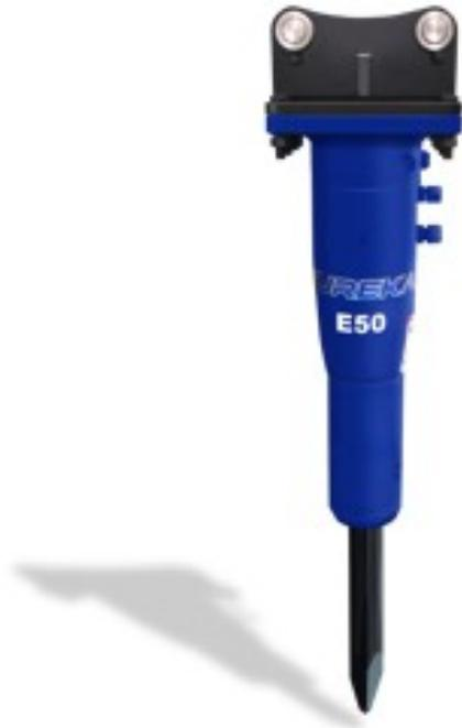
EUREKA 시리즈는 소위 일체형 브레이커 또는 원통형 브레이커, Monoblock 브레이커라 칭합니다. 일반적인 브레이커는 메인바디가 크게 3단으로 구성되어 Front Head, Cylinder, Head Cap을 Through Bolt와 Nut로 고정시킨 구조입니다. 그러나 EUREKA 브레이커는 Front Head와 실린더가 원통일체형 모노바디(Monobody)로 구성되어 있어 Through Bolt가 없어 기술적과 구조적으로 획기적인 제품입니다. 또한, 부품수가 적은 만큼 원가경쟁력이 높고 유지보수가 편리하다는 장점을 가지고 있습니다. 동 브랜드는 0.5~14톤급으로 총 8개 모델을 개발 완료하였습니다.
